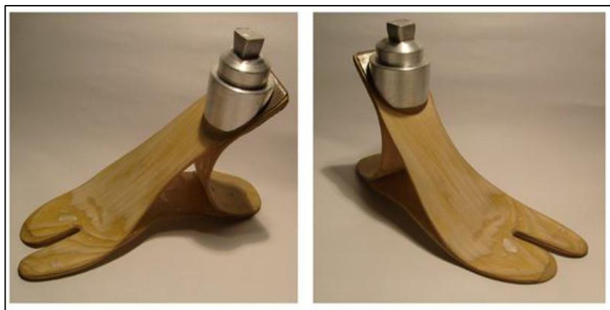
Figura 1.19 Prótesis fabricada de matriz epóxica reforzada con fibras de Guada Fuente: Universidad Pedagógica Nacional de Colombia [22].
