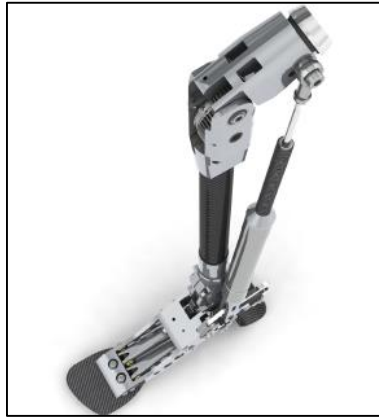
Figura 1.18 Diseño de prótesis pasiva desarrollado en Holanda Fuente: Design of a fully-passive transfemoral prosthesis prototype [110].
