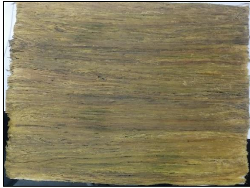
Figura 2.14 Lámina unidireccional de la especie Stipa Obtusa Fuente: Elaboración propia
