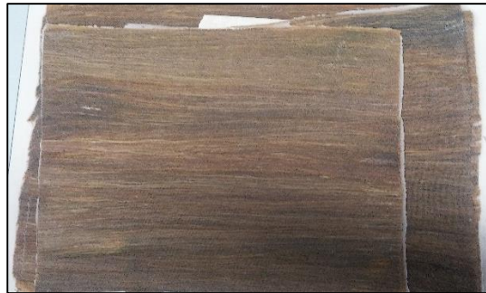
Figura 2.15 Fabricación de laminados de material compuesto de fibras de Ichu con matriz poliéster
