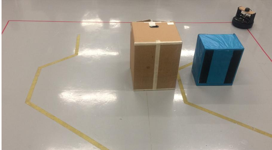
FIGURA 4.3: Navegación autónoma del robot diferencial Kobuki, montado con un sensor lidar y dos cajas como obstáculos.
