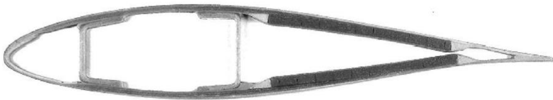
Figura 1.13 Sección de un álabe de turbina eólica Fuente: Martin O. L. Hansen. Aerodynamics of wind turbine. [23]
