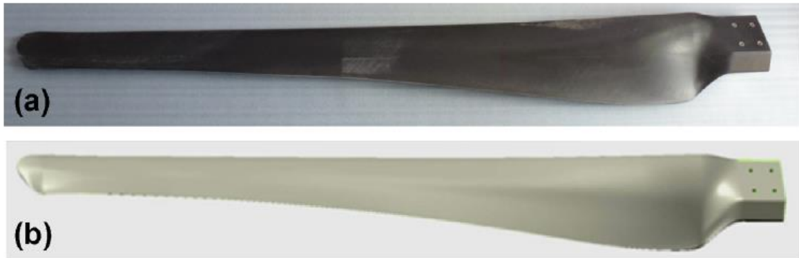
Figura 1.1 Comparación de álabes de turbina de (a) lino/poliéster y (b) Fibra de Vidrio/Poliéster. Fuente: Darshil.U, Shah, Peter J. Schubel*, Mike J. Cliffrod, Can flax replace E-glass in structural composites? A small wind turbine Blade case study [11]
