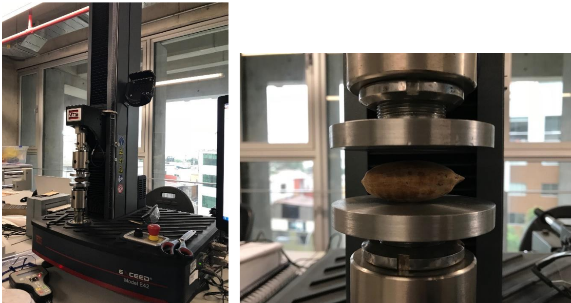
Figura 2.5 Ensayo de compresión en la máquina MTS E42 Fuente: Elaboración propia
