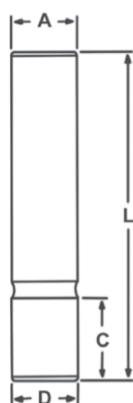
Figura 3.15 Ficha técnica del poste guía 5-0414-1 de la marca DANLY IEM Fuente: Catálogo de productos de Postes y Bujes de la marca DANLY IEM
