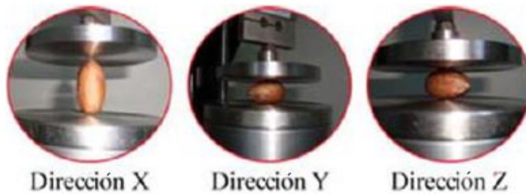
Figura 1.7 Prueba de compresión en las tres direcciones principales de la pecana
