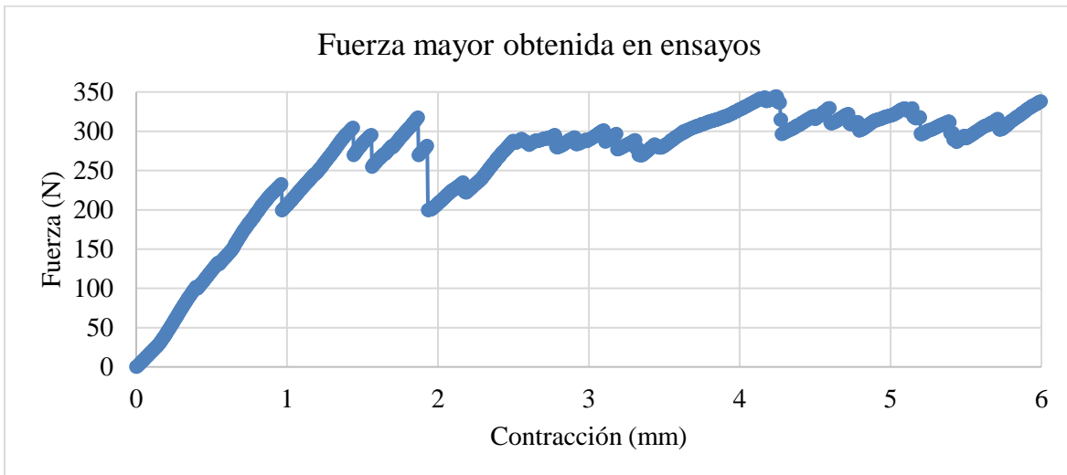
Figura 3.20 Fuerzas máximas obtenidas de los ensayos de compresión realizados a la pecana Fuente: Elaboración propia
