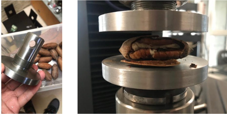
Figura 3.2 Elemento fabricado para la prueba de compresión para la máquina universal MTS E42 y estado de la pecana post-compresión Fuente: Elaboración propia
