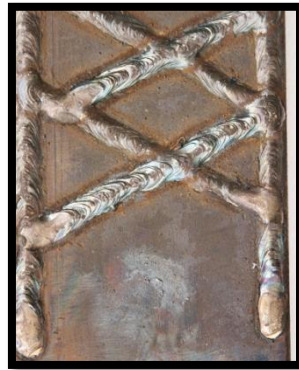
Figura I. Soldadura de blindaje doble hélice
