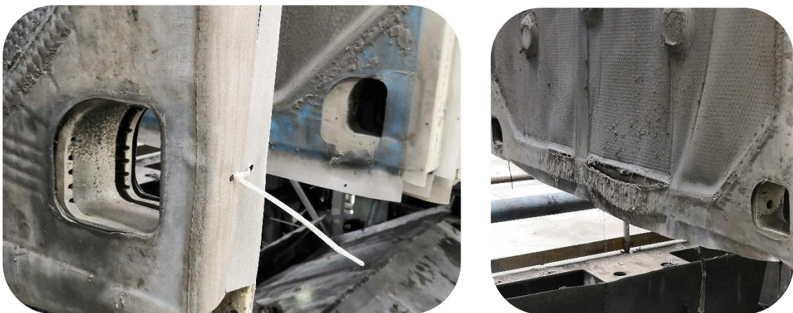
Figura 3.13 Evidencia de contracción y rotura en lonas de filtrado Fuente: Cesar Miranda. Visita a planta de procesamiento de mineral [31]
