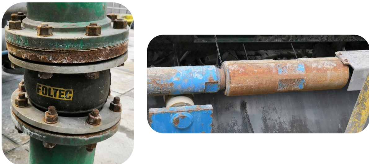
Figura 3.15 Evidencia de pegado de relave y desprendimiento de lonas de filtrado Fuente: Cesar Miranda. Visita a planta de procesamiento de mineral [31]
