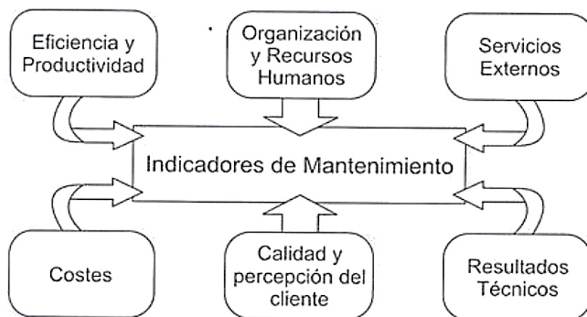
Figura 1.1 Factores de influencia sobre indicadores de mantenimiento Fuente: Francisco González. Auditoría del mantenimiento e indicadores de gestión [13]
