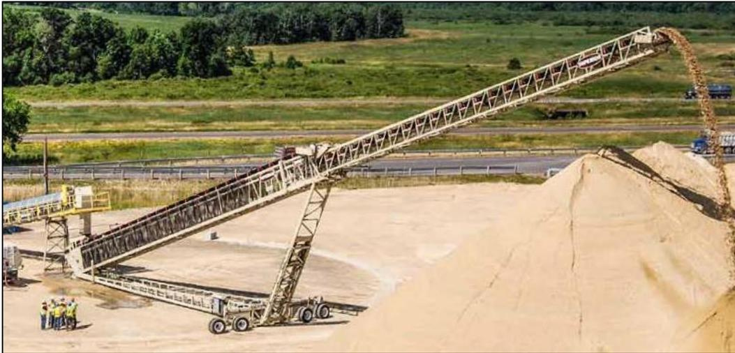
**Figura 1.1** Apilador telescópico marca Superior en funcionamiento.
