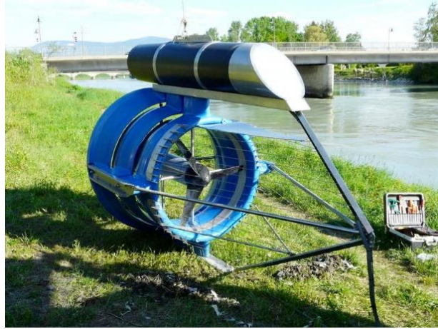
Figura 4.3 Turbina hidrocínética fabricada por SMART HYDRO POWER Fuente: Smart Hydro Power, Smart Monofloat: Proyecto de Conexión a Red en Rosenheim, Alemania [30]
