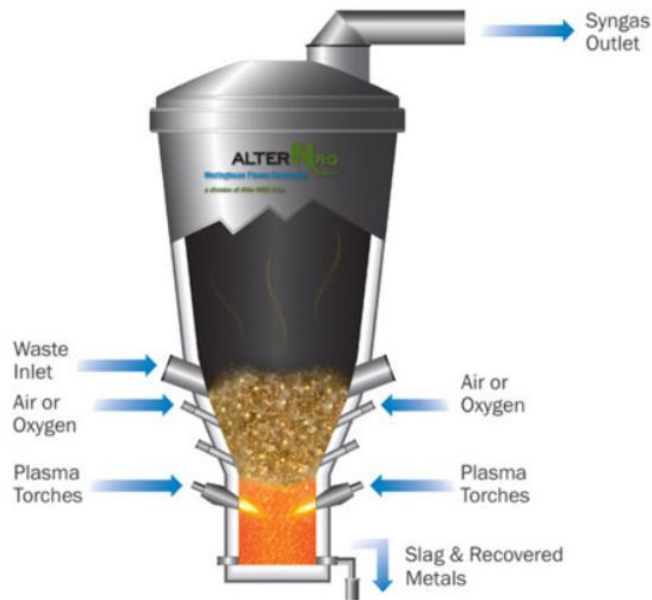
Figura 2.8 Esquema del gasificador plasma de la empresa AlterNRG Fuente: Material enviado por la empresa Alter NRG
