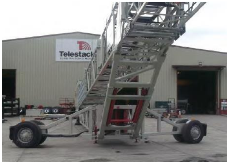
Figura 2.16 Sistema de levantamiento del apilador telescópico radial Fuente: Telestack Aggstack, Telestack Aggstack range demonstrating outstanding results [16].
