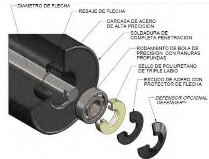
Figura 1.22 Piezas internas de una polea.
