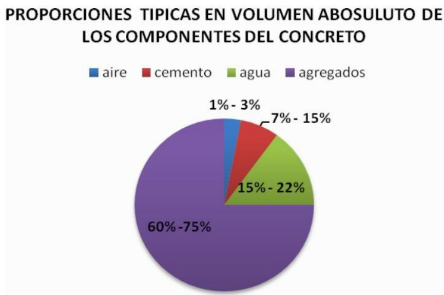
Figura 1.32 Proporciones típicas en volumen absoluto de los componentes del concreto. Fuente: C.Nmai, Aggregates for concrete [59].
