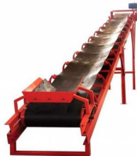
Figura 2.2 Modelo del sistema de transporte del apilador telescópico radial. Fuente: 911 Metallurgist, fajas transportadoras [63].
