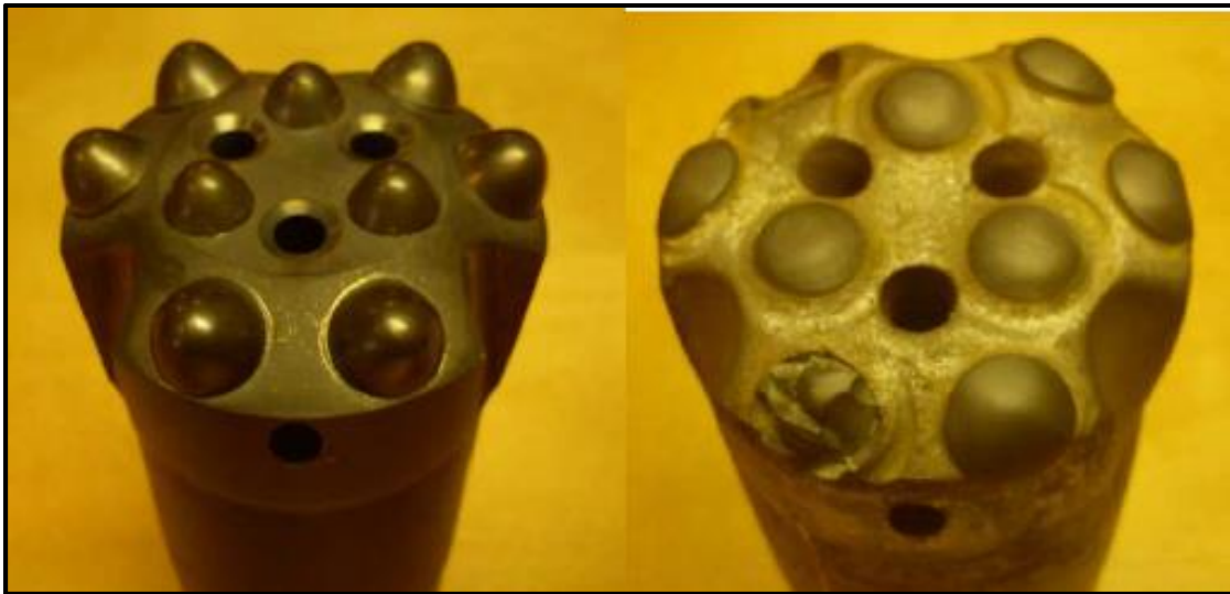
Fig. 1.3 Broca de botones sin desgaste y broca desgastada. Fuente: Jakob Oskarsson, Tribological testing of drill bit inserts [19].
