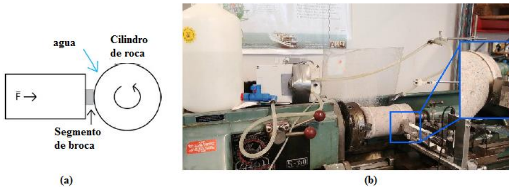
Fig. 1.8 (a) Esquema del ensayo en laboratorio (b) Configuración del ensayo, bomba de agua a la izquierda, cilindro de piedra en el medio. En el cuadro azul, se observa el porta muestras ejerciendo una carga sobre la probeta.
