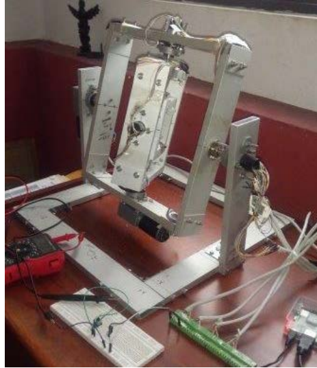
Figura 38 Primeras pruebas de la máquina de 3GDL ensamblada.
