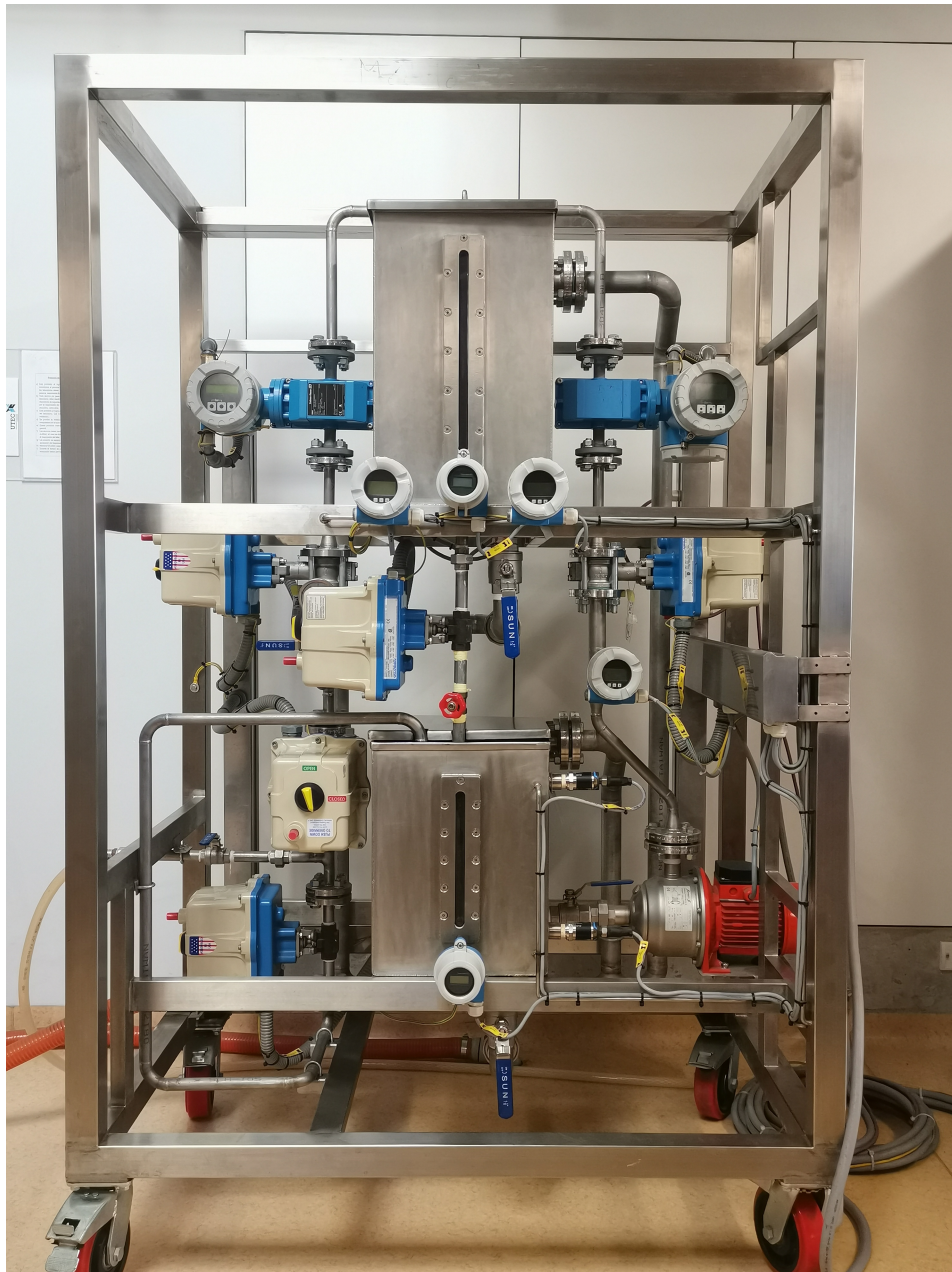
FIGURA 2.1: Planta multipropósito industrial [2].
