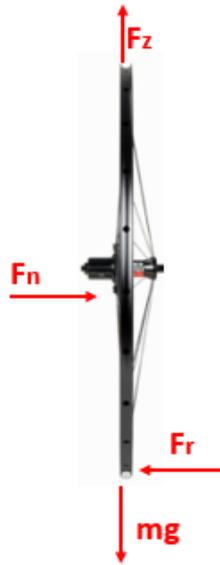
Figura 1.25 DCL neumático directriz delantero.
