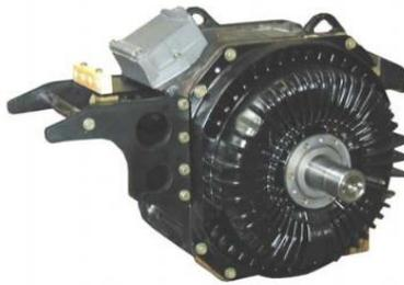
**Figura 1.6.** Motor Asíncrono de 4 polos del Tren Alstom modelo Metrópolis S9000
