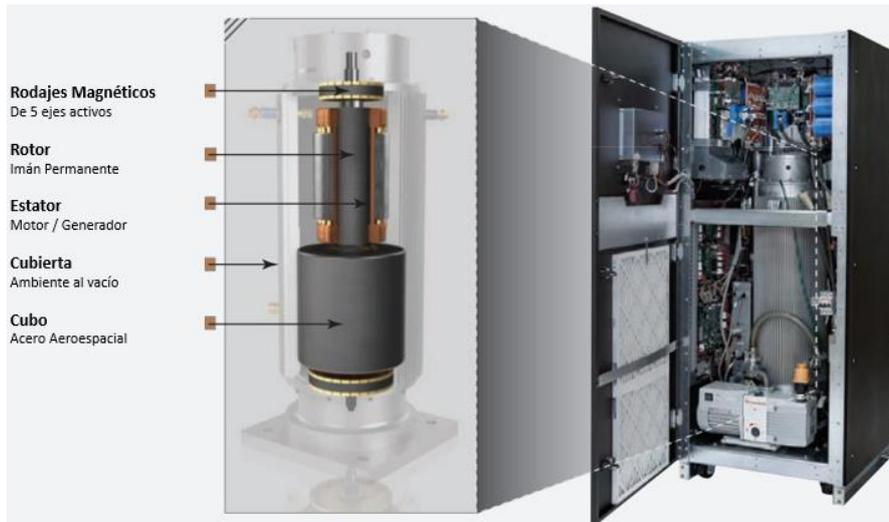
**Figura 1.19.** Partes principales de una Rueda de Inercia de la empresa Calnetix, VYCON Regen
