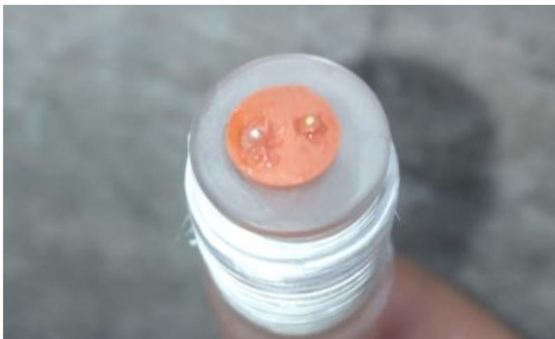
FIGURA 4.3: Vista frontal de electrodos auxiliar y de trabajo encapsulados
