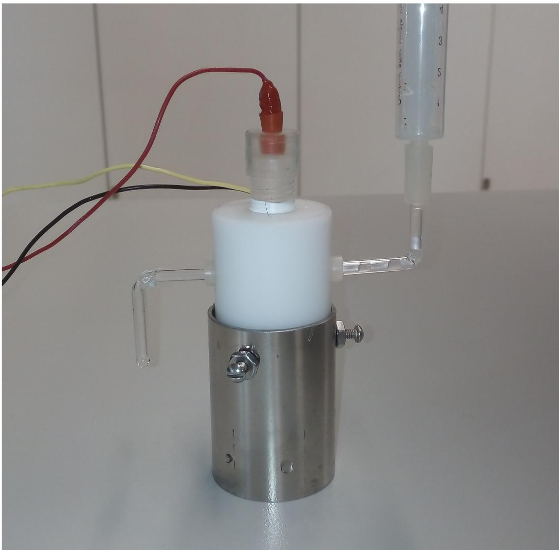
FIGURA 4.5: Celda de 3 electrodos montada
