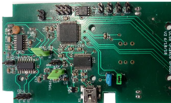
FIGURA 4.1: Implementación de la placa potencióstato
