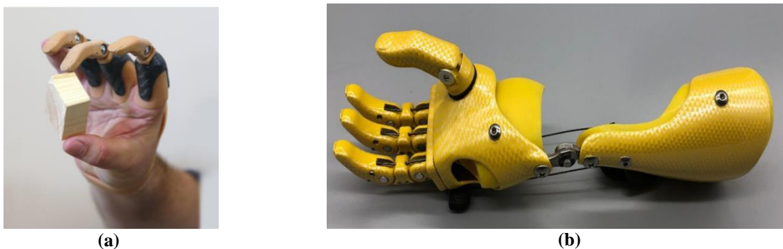
Figura 1.17. M y Partial M Fingers (a) Partial M – Fingers sosteniendo un bloque de madera. (b) M-Fingers incluyendo el pulgar. Fuente: Adaptado de [47]
