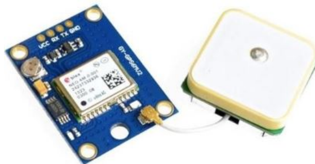
FIGURA 3.11: NEO-6 GPS. Referenciado de [29].
