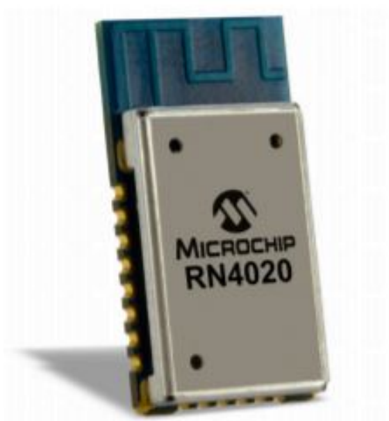
FIGURA 3.14: Módulo bluetooth low energy (BLE). Referenciado de [33].
