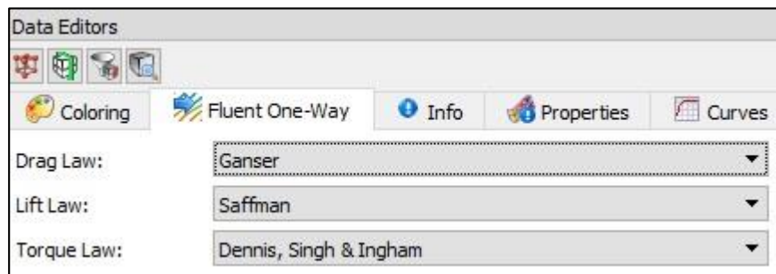
Figura 2.33 Configuración de las leyes de arrastre, elevación y torque para un acople unidireccional con partículas no-esféricas como las de la presente investigación. Fuente: Elaboración propia a través del software Rocky DEM.
