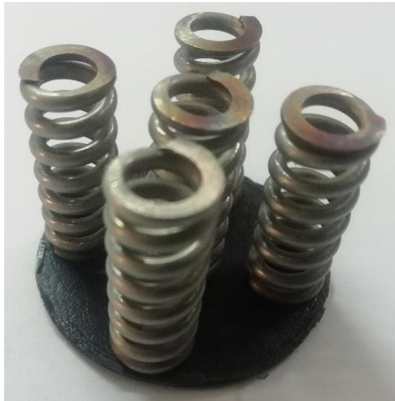
Figura 3.13 Resortes mecanizados en base a las características del sistema Fuente: Elaboración Propia
