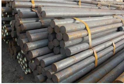
Figura 1.4 Medio Molturantes en forma de Barras Fuente Anónimo. Nodular cast Iron Bar [35]
