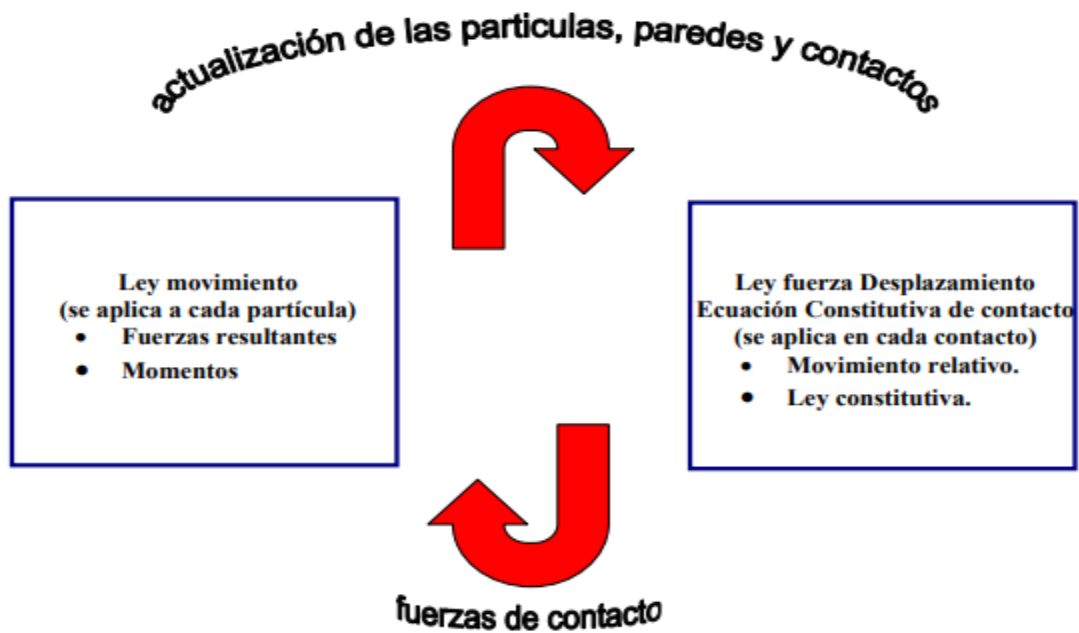
Figura 1.23 Proceso de cálculo para Análisis en Elementos Discretos
