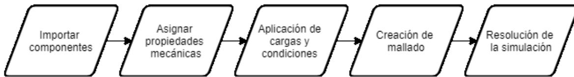
**Figura 2.9.** Flujograma de simulación por método de elementos finitos
