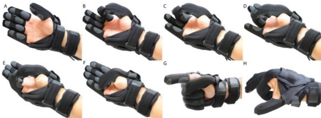
**Figura 1.26** Aplicación del actuador blando reforzado con fibra en un guante de rehabilitación [55]
