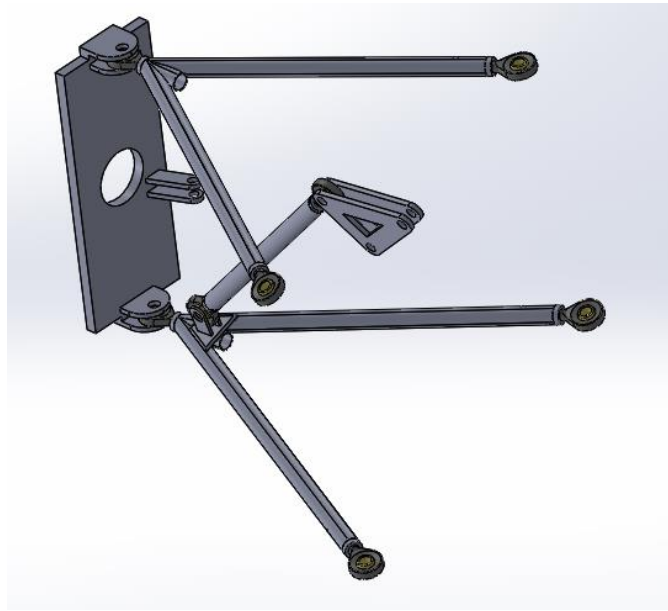
Figura 2.13: Vista 3D de la suspensión delantera Extraído de: Elaboración propia en Solidworks
