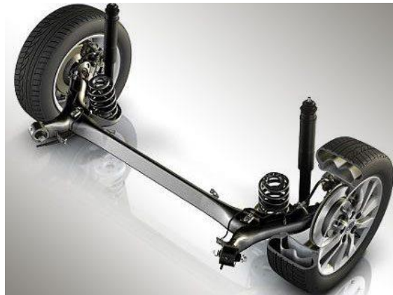
Figura 1.2 Viga de torsión Fuente: Tipos de suspensión [10]
