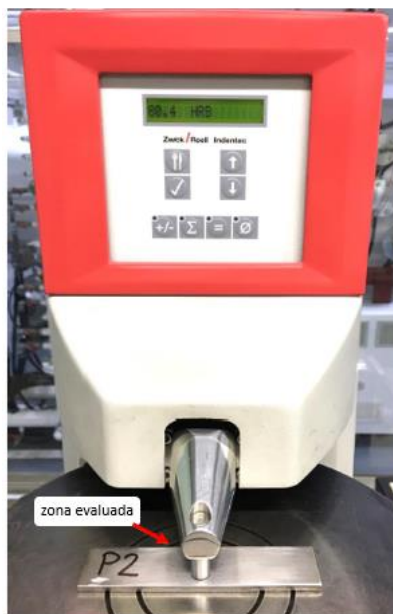
Figura 2.8 Ensayo de dureza Rockwell B Fuente: Elaboración propia
