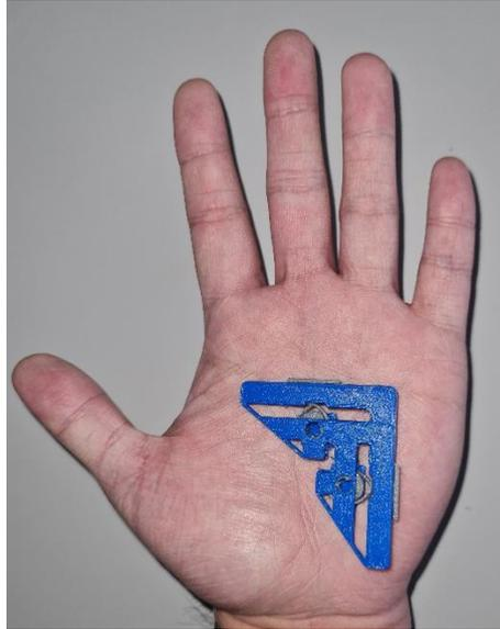
**Figura 3.24.** Posición del actuador sobre la palma de la mano.
