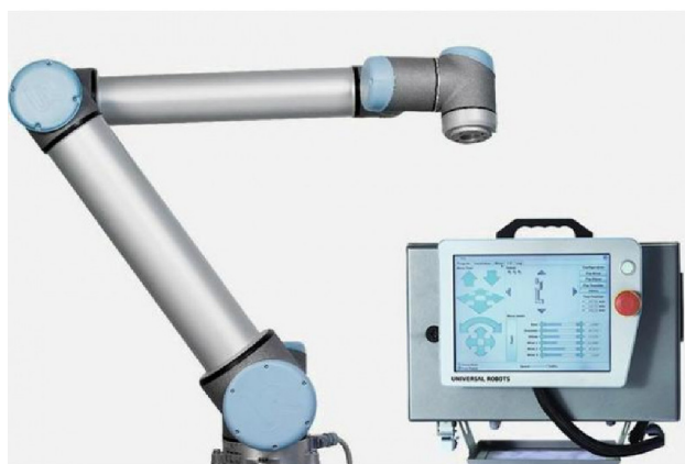
FIGURA 3.5: Robot UR5 con caja de control y pantalla táctil 1 .
