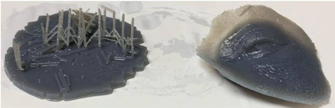
**Figura 3.18:** Modelo óculo-palpebral luego del post proceso
