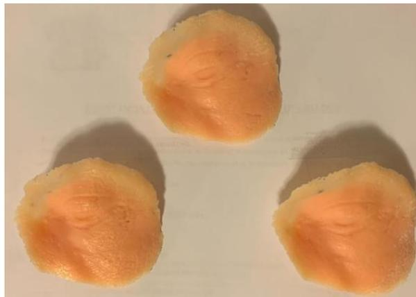
**Figura 3.11:** Modelos óculo-palpebrales impresos en el equipo DS-200
