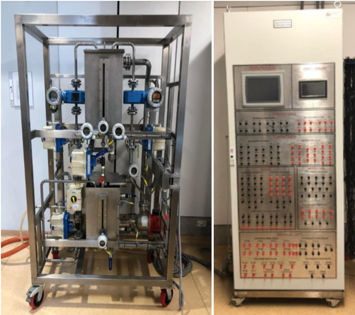
*Figura 2.1:* Equipo de control de procesos. Planta industrial multipropósito para control e instrumentación (Figura de la izquierda). Módulo industrial multipropósito para control y supervisión (Figura de la derecha).
