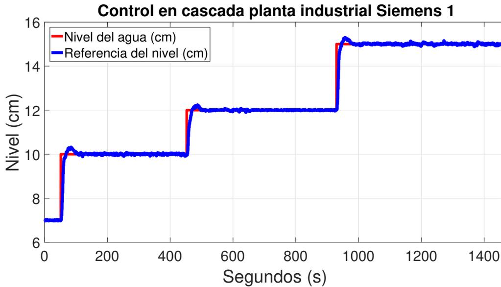
Figura 5.6: Control en cascada implementado en la planta industrial Siemens 1.
