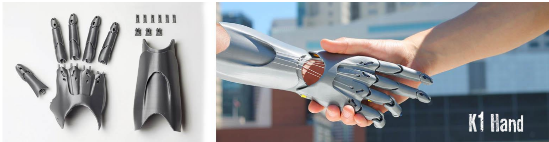
Figura 1.16. Prótesis mecánica K1 Hand Fuente: Adaptado de [46]
