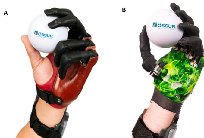
Figura 1.22. A. i-Digits™ Quantum. B. i-Digits Access Fuente: Adaptado de [55], [56]
