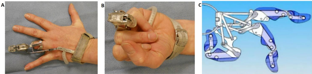
Figura 1.18. A. Vista dorsal del X-Tips en el dedo anular. B. Flexión de la prótesis. C. Mecanismo de funcionamiento de la prótesis Fuente: Adaptado de [40]
