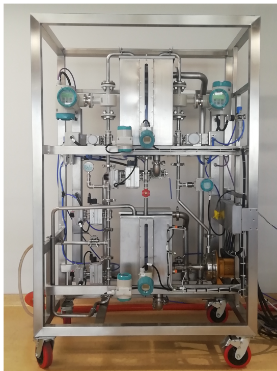
FIGURA 2.1: Planta industrial multipropósito para control e instrumentación.
