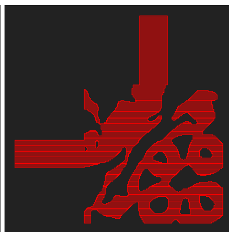
(f) Representación GDSII del diseño nominal tras eliminar regiones no conexas.
