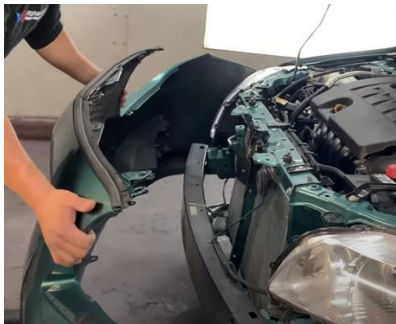
Figura 2.19 Vista del parachoques tras retirar fascia en vehículo sedán. [21]
