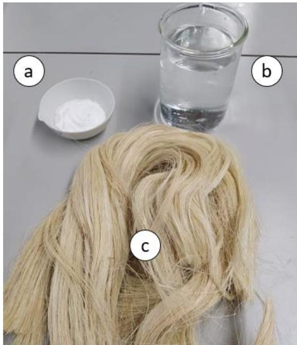
**Figura 2.2.** Materiales a utilizar en el tratamiento: a) bicarbonato de sodio, b) agua destilada y c) parte central de cabuya.
