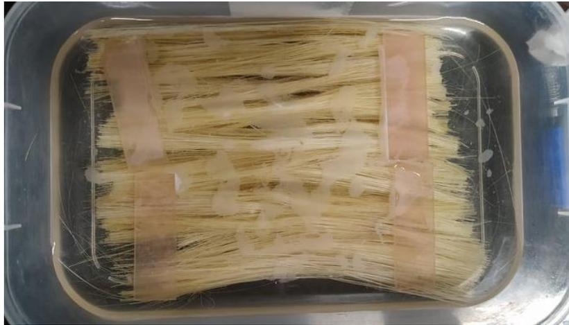
**Figura 2.4.** Fibras de cabuya sumergidas en tratamiento con bicarbonato de sodio.
