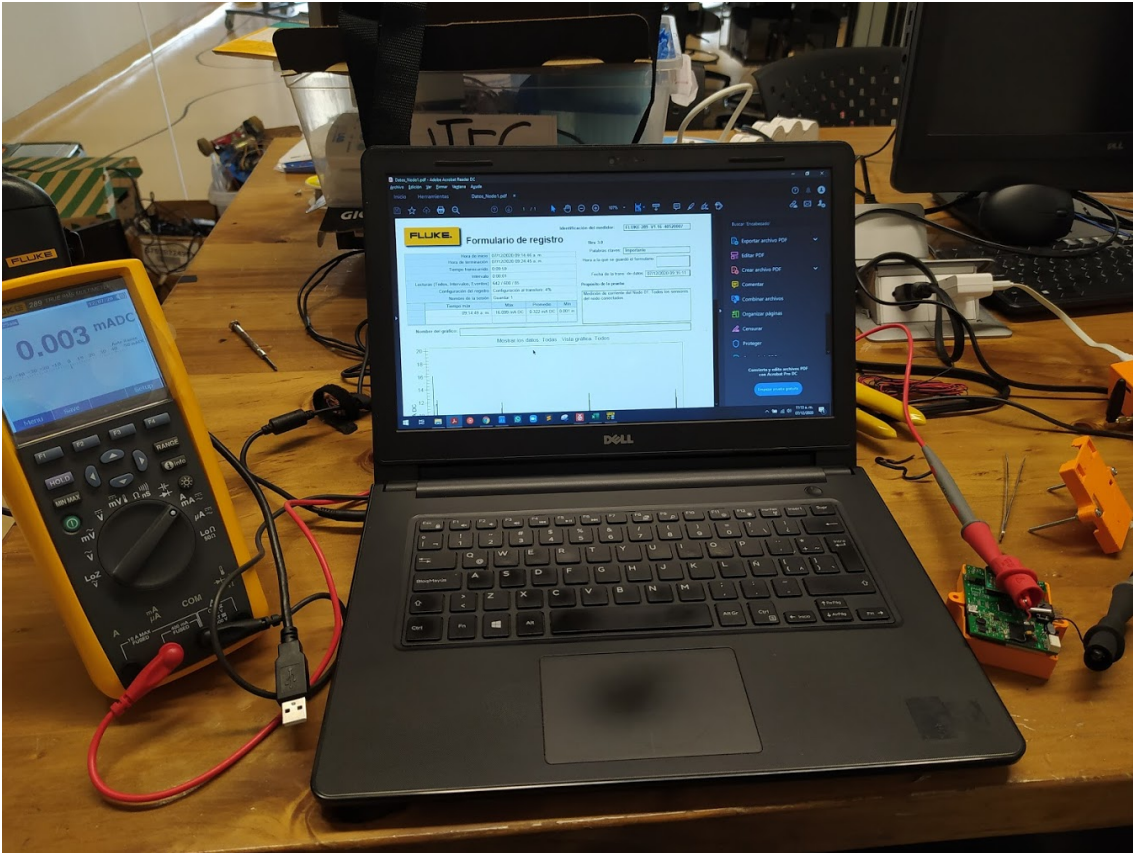
FIGURA 4.8: Medición de corriente de un nodo con el multímetro Fluke 289.
