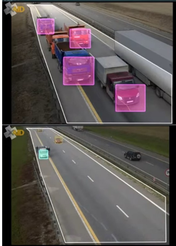
FIGURA 1.1: Análisis de escenas de tráfico utilizando el software XAID. En la imagen superior, se observa que el programa no puede detectar el camión naranja, ubicado detrás del camión azul, debido a que se encuentra a muy poca distancia. En la imagen inferior, de igual manera, el automóvil gris no permite al programa reconocer el vehículo detrás de él.
