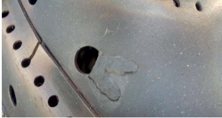
Fig. 3.11. Fotografía de rajadura en el hoyo de dilución del primer anillo externo de la cámara de combustión del motor AI-20D-5
