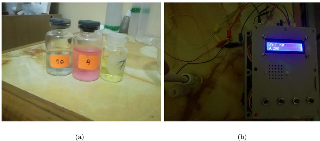
FIGURA 4.47: Soluciones buffer de 4, 7 y 10 pH (a) empleadas para la calibración del sensor de pH (b).
