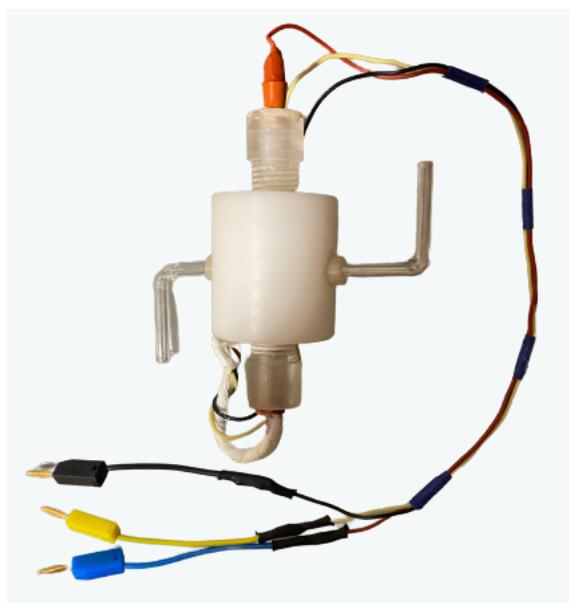
FIGURA 4.3: Celda voltamperométrica. Cable amarillo: electrodo de trabajo, cable rojo: electrodo de referencia y cable negro: electrodo auxiliar.
