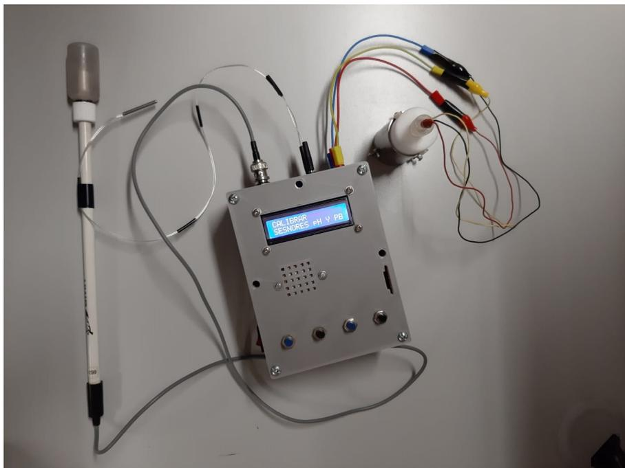
FIGURA 5.4: Vista externa del sistema portátil de adquisición de concentración de plomo
