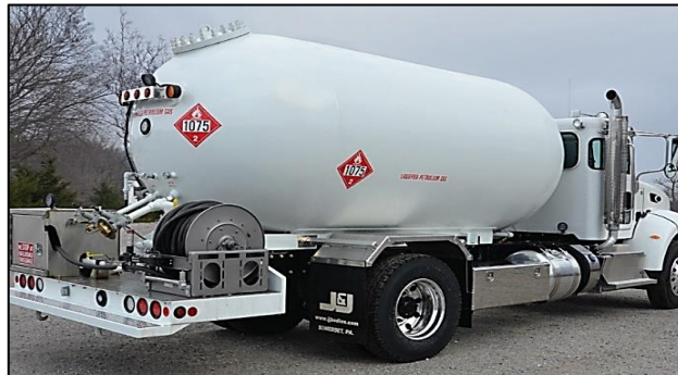
Figura 1.12 Recipiente sobre Chasis [43]
