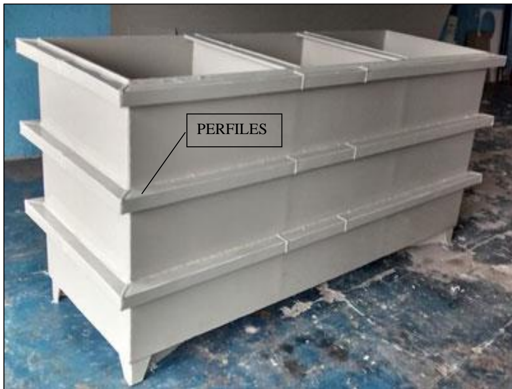
Figura 1.5. Tanque metálico rectangular reforzado con perfiles.[24]
