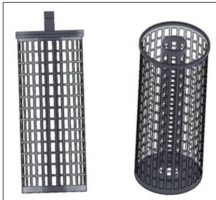
Figura 3.13. Cartucho con agujero de forma rectangular.
