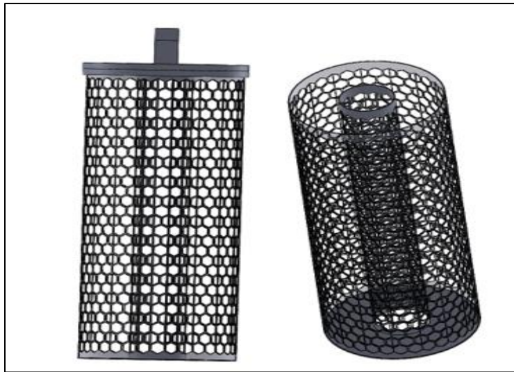
Figura 3.14. Cartucho con agujero de forma hexagonal.
