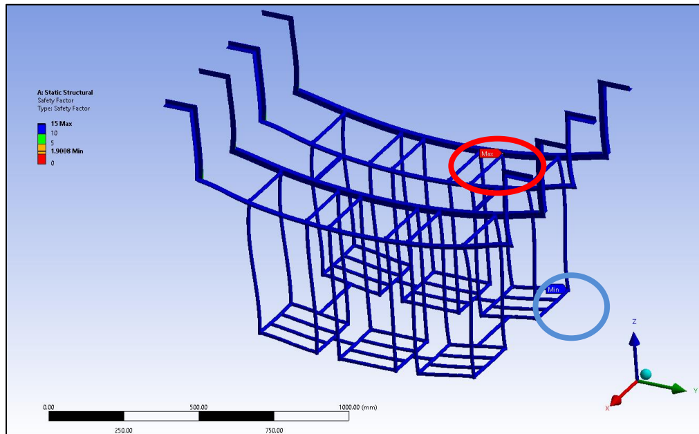
Figura 3.38. Resultado del factor de seguridad dado por el análisis estático.
