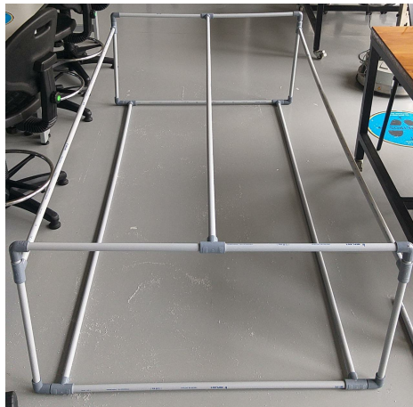
FIGURA 3.10: Estructura en forma prismática de 90 centímetros de ancho por 200 centímetros de largo por 60 centímetros de alto usando tubos de PVC .
