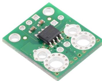
FIGURA 4.10: Sensor de corriente ACS724.
