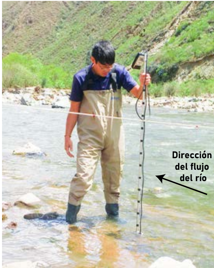
FIGURA 4.17: Aforo con correntómetro en el río Huallaga, Ambo, Huánuco, aguas abajo de la confluencia de los ríos Huallaga e Higueras. Fecha: 08/11/2020. Ancho del río: 32.5 m, Tirante máximo: 1.2 m, Caudal: 12.86 m 3 /s. Realizado por CITA-UTEC.
