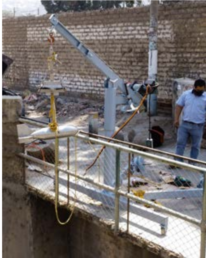
FIGURA 4.10: Sistema de muestreo de sedimentos tipo grúa, propiedad de CITA-UTEC, para uso desde puentes. Fotografía tomada en 2020
