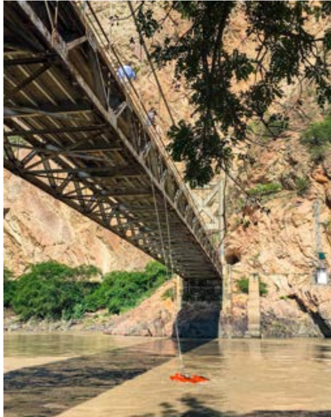
FIGURA 4.15: Medición con ADCP desde un puente en el río Alto Marañón cerca de la ciudad de Balsas en la Región Amazonas. CITA-UTEC, 08/2019.
