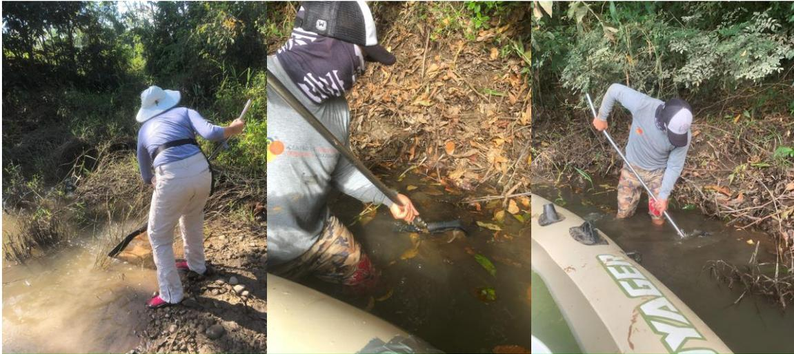
**Figura 4.2.** Colecta de macroinvertebrados con la red de nylon D-net de 500 µm.
