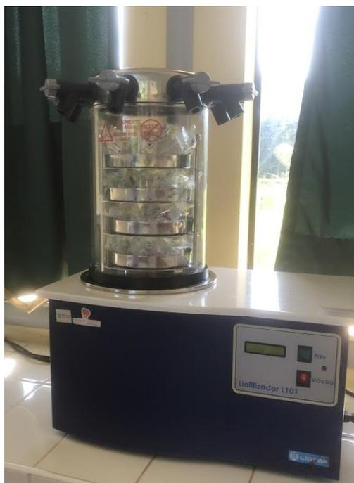
**Figura 2.7.** Secado de muestras de zooplancton y macroinvertebrados en el liofilizador Liobras L101 de LAMQA.
