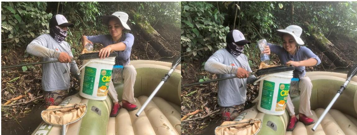
**Figura 4.4** Transferencia de la muestra al balde.
