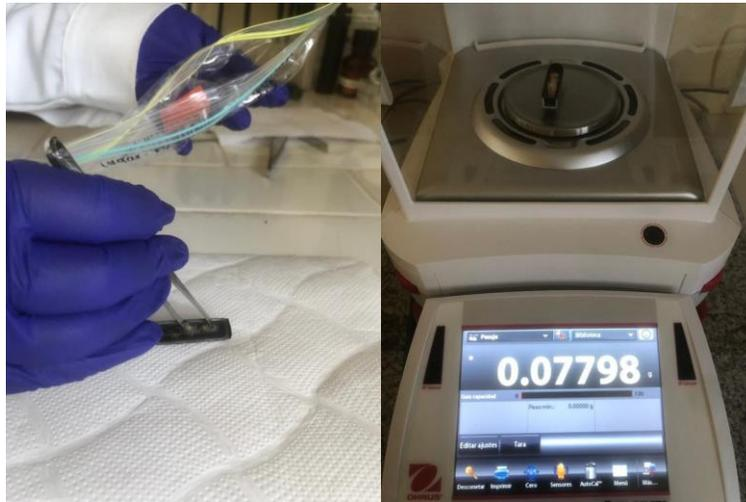
**Figura 8.1** Preparación de un bote de muestra y pesaje.
