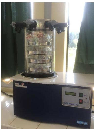
**Figura 7.4** Secado de las muestras en el liofilizador Liobras L101.
