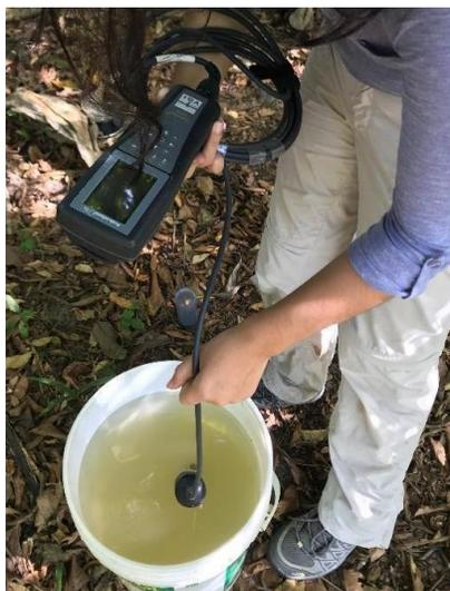
**Figura 5.2** Toma de parámetros fisicoquímicos con el multiparámetro.
