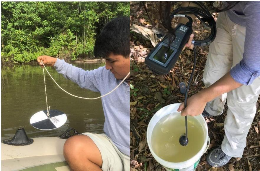
**Figura 2.5.** Toma de datos ambientales de apoyo. Disco Secchi (izquierda) y multiparámetro (derecha).
