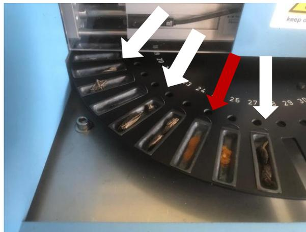
**Figura 8.2** Botes con muestra (flechas blancas) y botes con material de referencia certificado (flecha roja).
