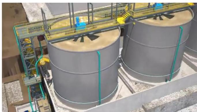
**Figura 2.3.** Estructura del circuito de cianuración con tanque agitador. De [37]
