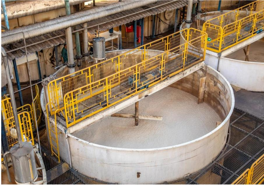
**Figura 2.6.** Modelo de barandas y escalera sobre tanque. De [38]
