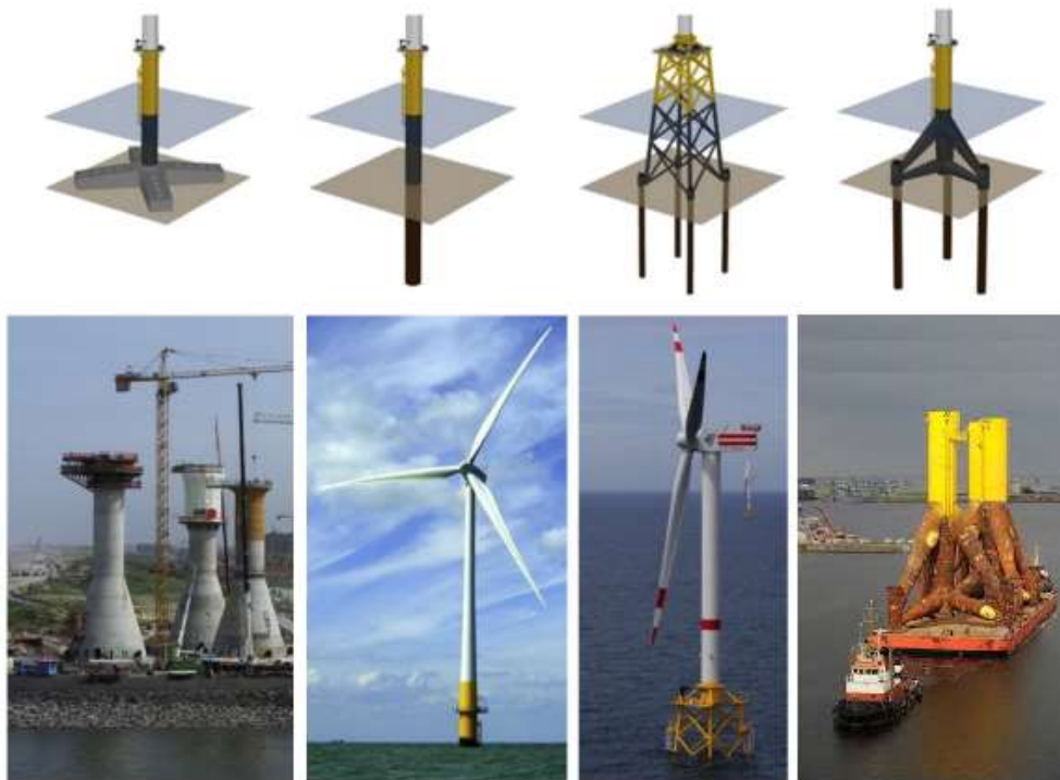
Figura 1.1 Estructuras del tipo bottom-fixed (de izq. a derecha: de gravedad, monopila, jacket y trípode) [39].
