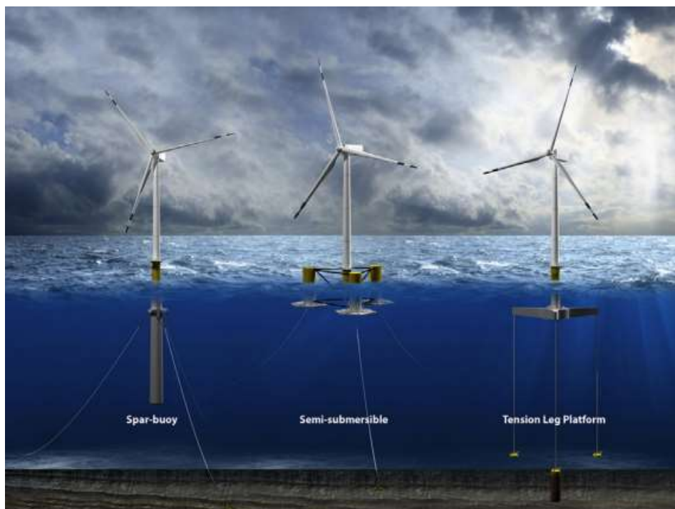
Figura 1.2 Estructuras del tipo flotante [39].
