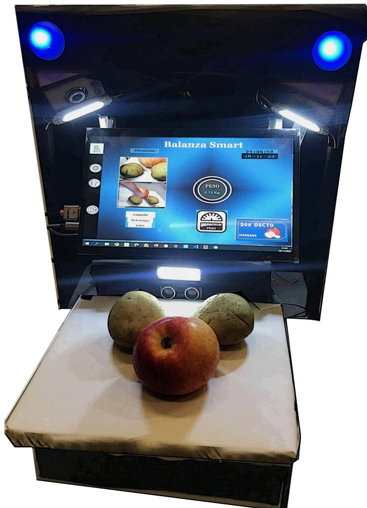
FIGURA 0.36: Detección completada de producto y peso con indicador de luz azul.
