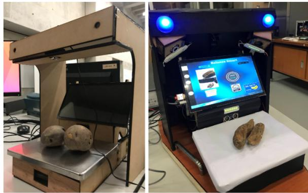
FIGURA 4.4: Comparación entre usos de 1 o 2 cámaras.
