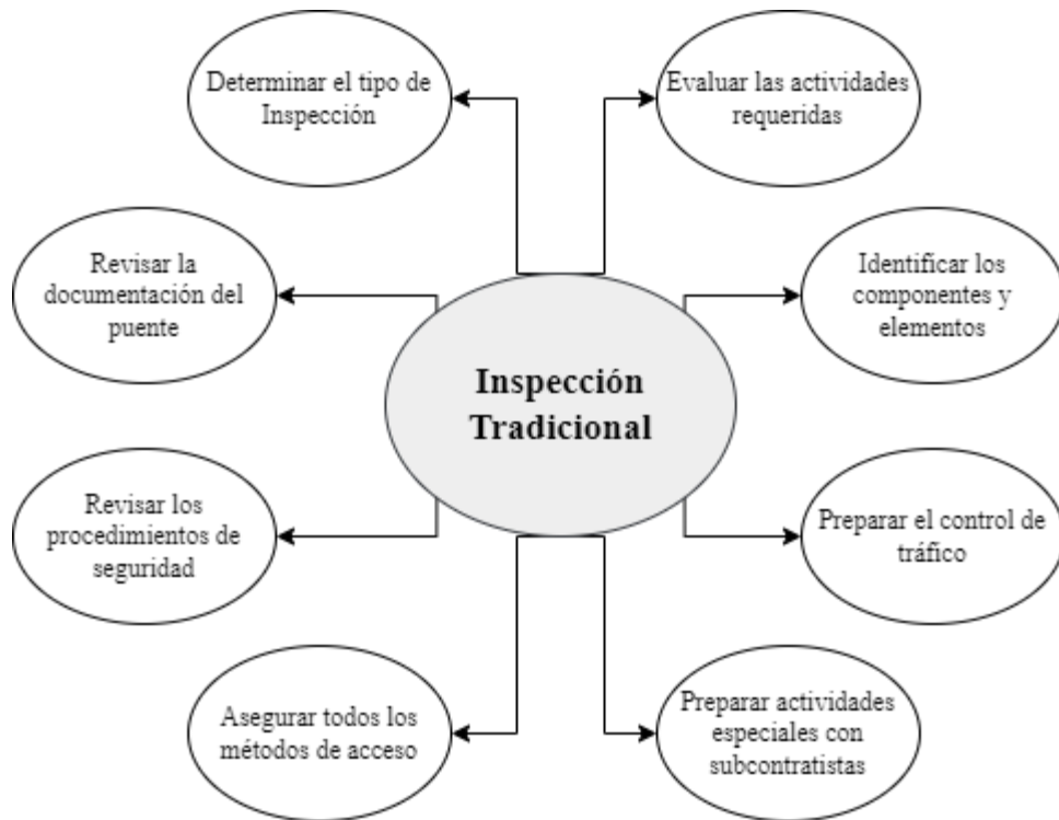
Figura 6. Gráfico de la inspección tradicional (Adaptado de [23])
