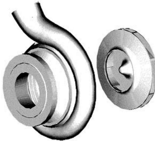
Figura 1.1: Diagrama de Bomba Centrífuga [10]
