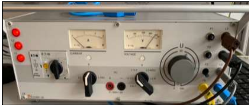
Figura 7. Fuente de alimentación de 2000W.
