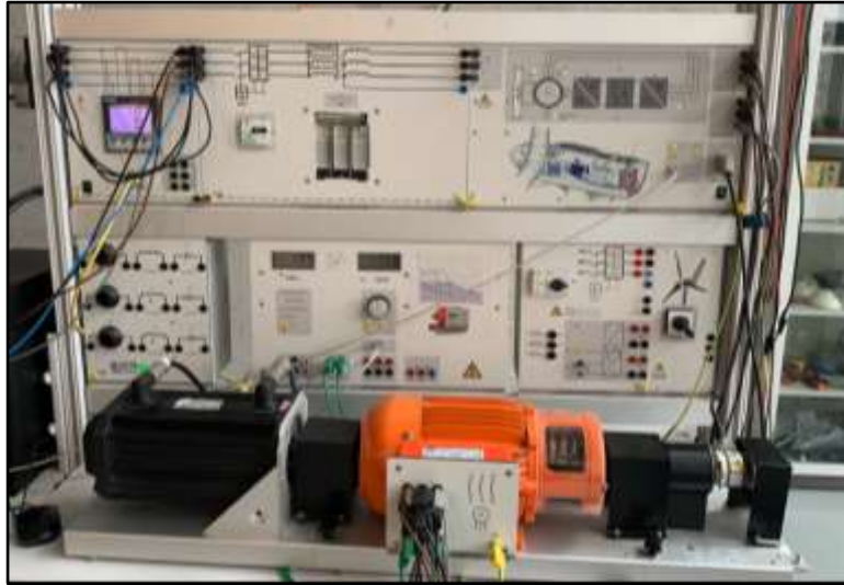
Figura 14. Módulo del aerogenerador.
