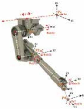
Transformaciones lineales de dimensión finita, aplicadas al desarrollo del modelo cinemático directo para el robot KUKA KR 60 JET.
