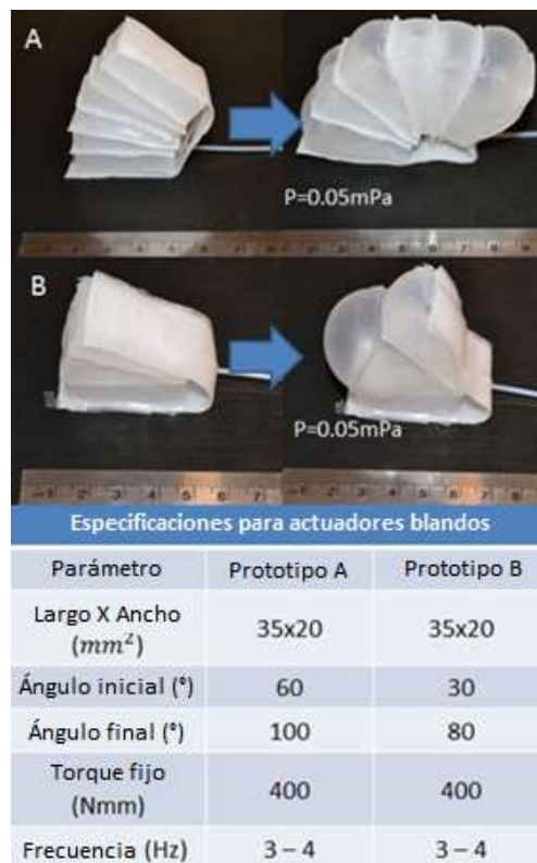
Figura 2.21: Especificaciones del actuador de referencia, adaptado de [104]
