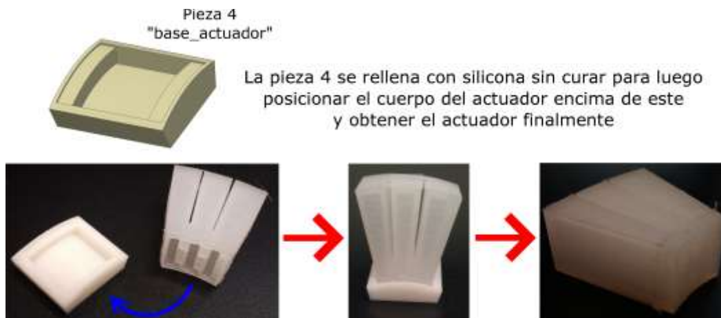
Figura 2.27: Detalle de la pieza 4 para la base del actuador, junto con el cuerpo del actuador y el actuador sellado
