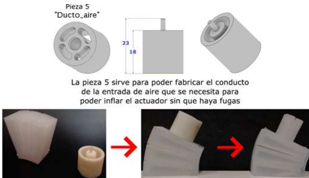
Figura 2.28: Detalle de la pieza 5 que genera el ducto para la entrada de aire
