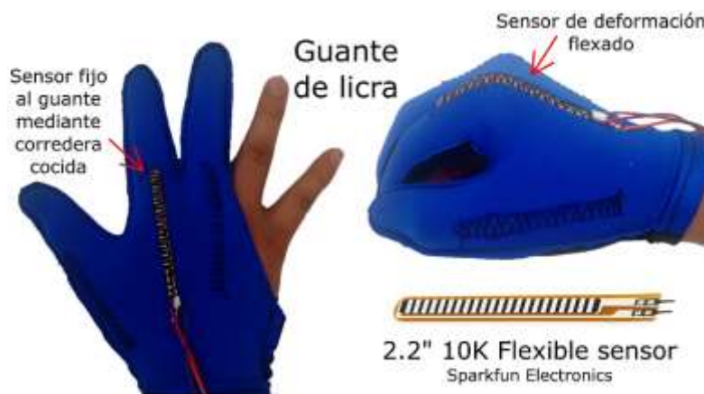
Figura 4.2: Guante con sensor de deformación fijado para el dedo índice
