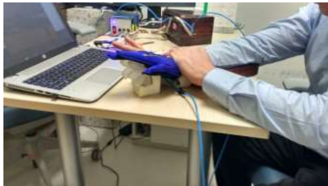
Figura 4.7: Movimiento hasta el rango máximo de la articulación metacarpofalángica del paciente guiada por el actuador de los dedos índice y medio
