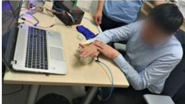
Figura 4.6: Prueba de movimiento pasivo continuo con el paciente para los dedos índice y medio
