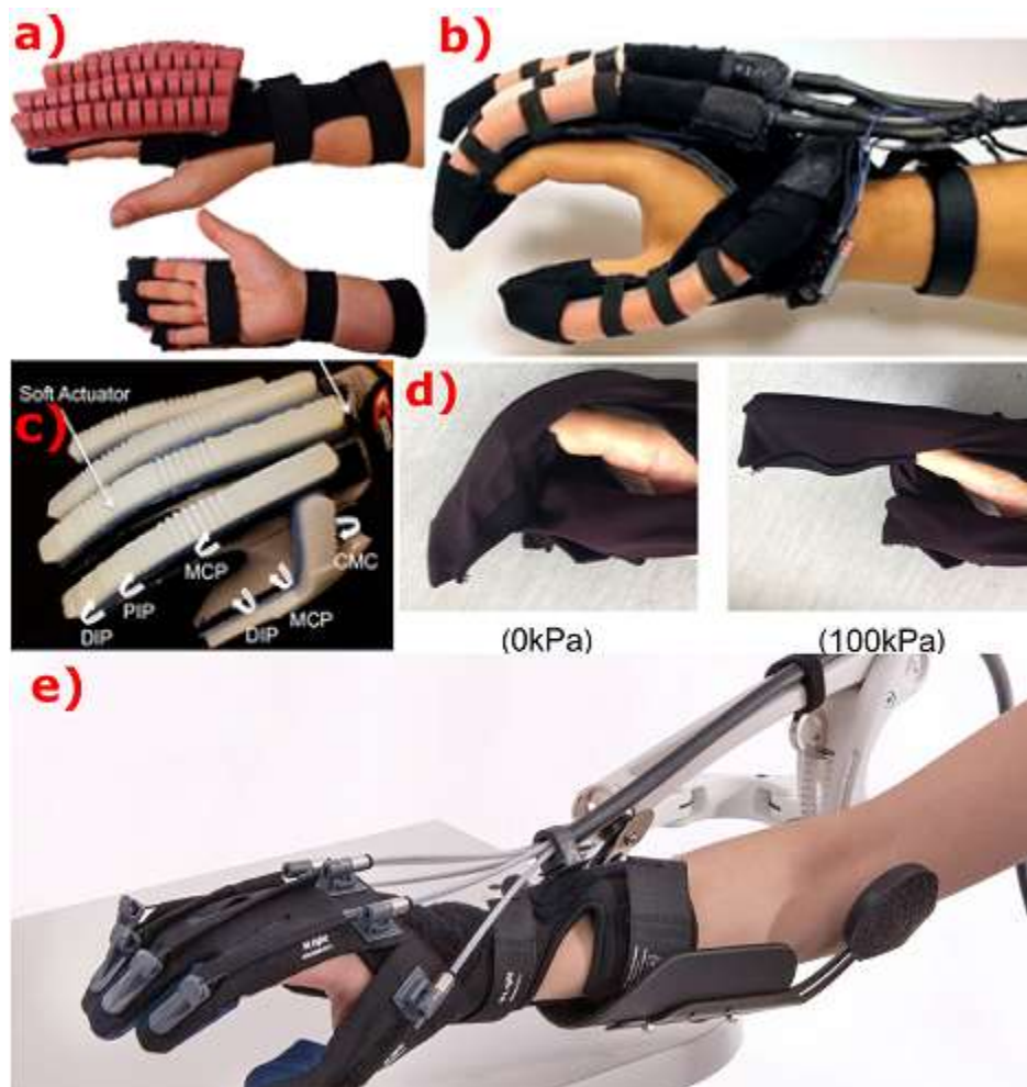
Figura 1.6: Dispositivos para rehabilitación para dedos basados en robótica blanda. a) Polygerinos et al. (2013) [82], b) Polygerinos et al. (2015) [65], c) Yap et al. (2015) [68], d) Yap et al. (2016) [83] y e) Gloreha [84]
