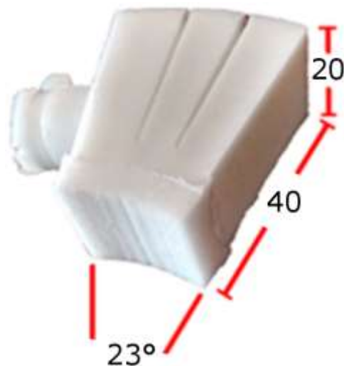
Figura 2.23: Primer actuador fabricado con medidas iniciales, unidades en milímetros y grados
