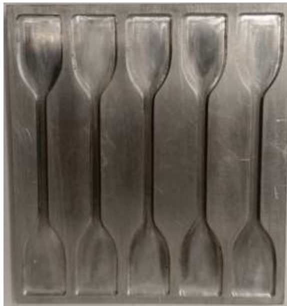
Figura 2.9: Molde utilizado para la fabricación de las probetas para el ensayo de tracción
